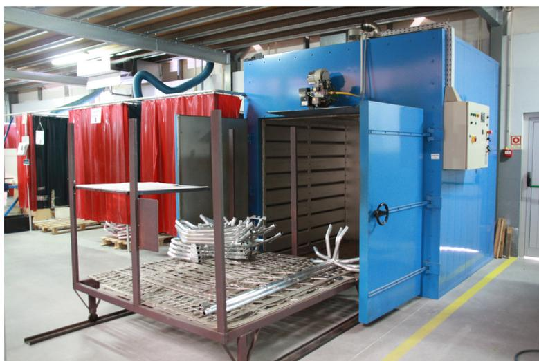
Figura 6 - Forno de Tratamento Térmico
