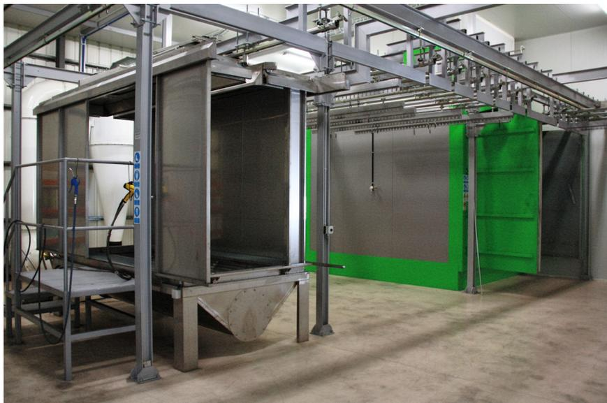
Figura 8 - Cabine de Pintura com Estufa de Polimerização
